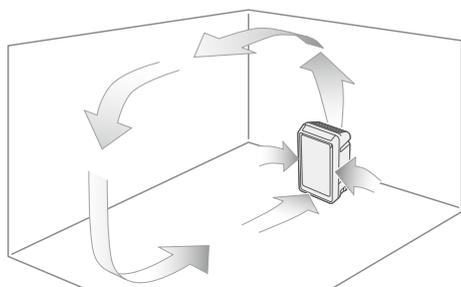
Прибор останавливается автоматически после очистки воздуха. После приостановки работы на 50 минут, прибор возобновляет на 10 минут работу в режиме патрулирования.
