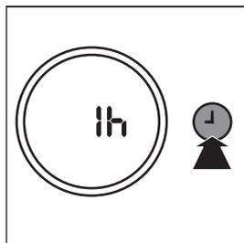
↳ Таймер позволяет установить время от 1 до 24 часов.
